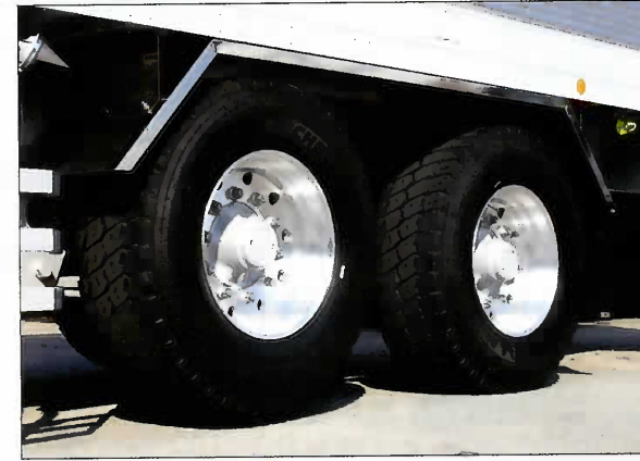
セミトレーラは日本フルハーフ製。ギガントSMB製2軸エアサスアクスル付セパレートフレームシャシに、アルミコルゲートパネルのバンボデーを架装。最大積載量は19,000kg。リフトアクスルも備える。
